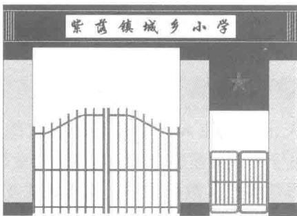
利用 AutoCAD 绘制完成“校门”二维线框图之后，可以将其调入 3ds Max 中进行建模，3ds Max 拥有强大的建模及渲染功能。在 3ds Max 中调用 AutoCAD 创建的二维线框图建模的优点是结构明确，易于绘制、编辑，而且绘制出来的模型将更加精确。利用 3ds Max 软件将模型创建完成之后，还可以为其添加材质、灯光及摄影机，并进行相应渲染。
