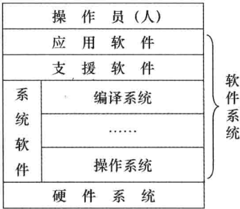
图 1.1 计算机系统的层次结构
