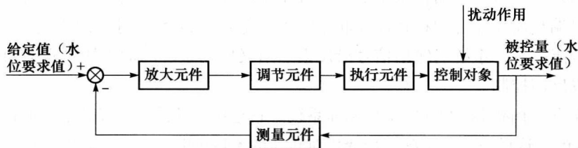
图 1.3 水位自动控制系统的方框图
