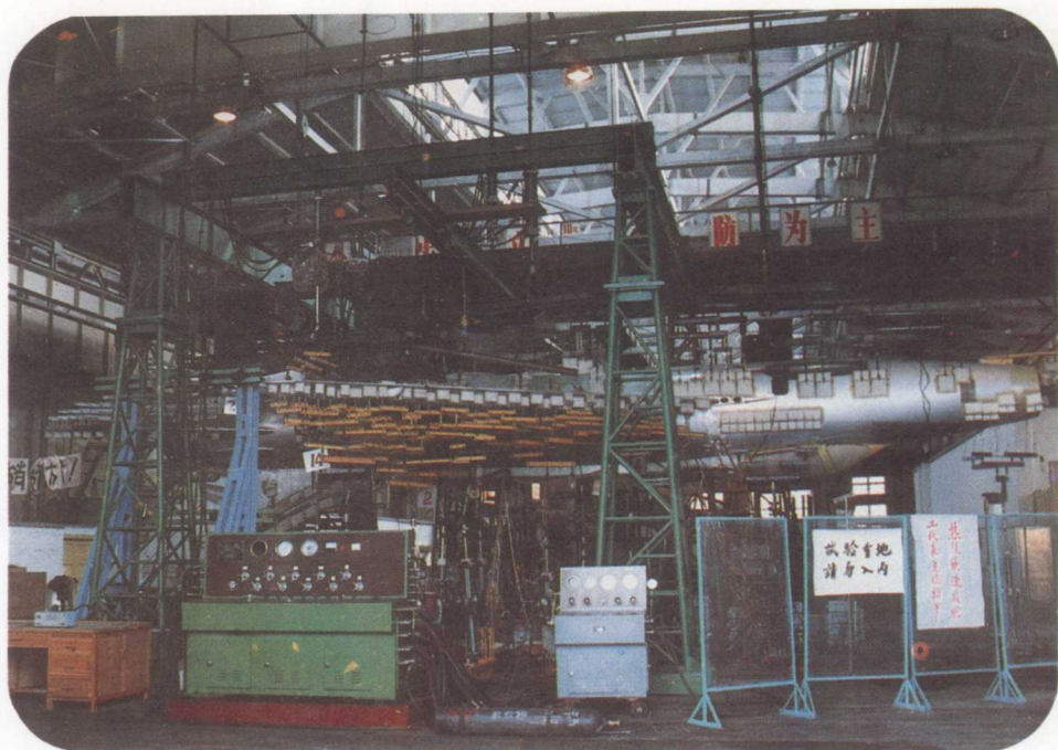
歼七II型飞机机体疲劳试验
