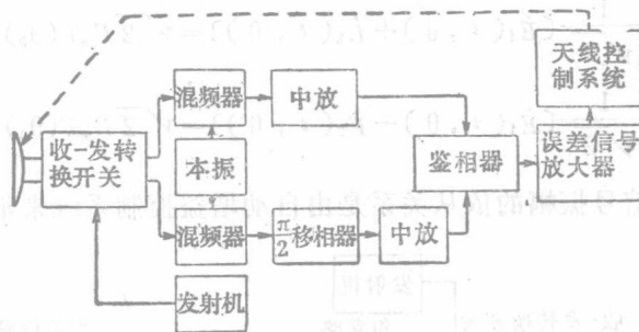
图1-8 在一个平面内跟踪目标的相位-相位式单脉冲雷达的方框图
