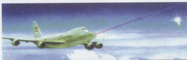
↓ 美国空军机载激光武器系统在助推段拦截弹道导弹
