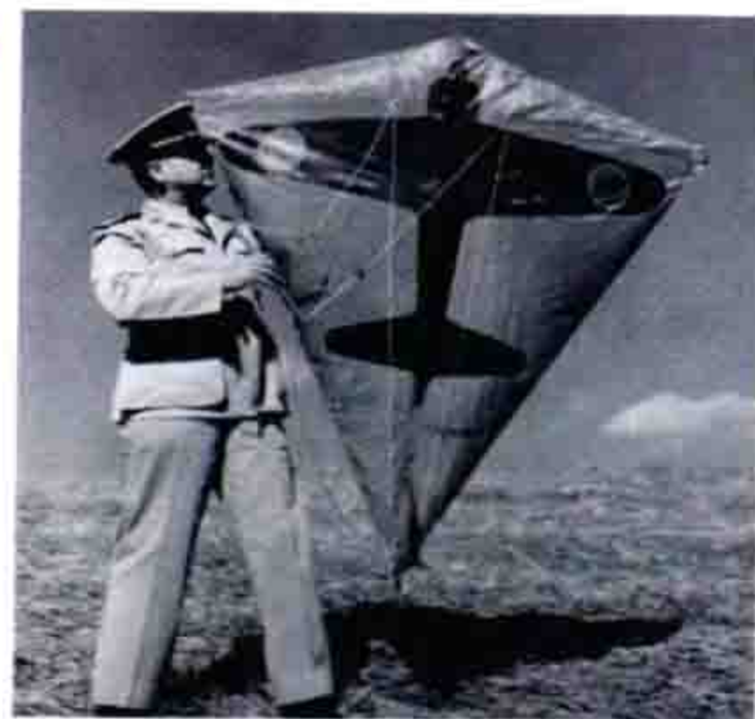
▲ 受中国风筝启发，1904年起，旅居英国的美国人科迪（Cody）开始为英军设计制造载人观测风筝，这种巨大的箱式风筝能悬挂一个吊篮，容纳一名士兵，升空去侦察敌情，当然下面得有一队人通过绞盘操纵风筝。这是1906年拍摄的科迪载人军用侦察风筝升空场景。
