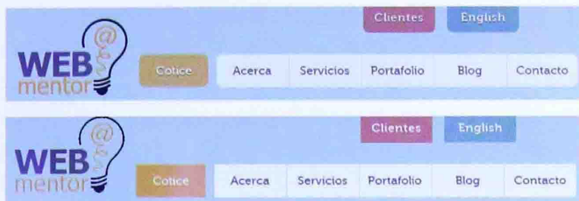
图1-10 用CSS3的border-radius做的webmentor.cr导航标签,在最新的谷歌、火狐等浏览器中都可以正常渲染,看得到圆角(上图),而使用IE 6.0和8.0等过时浏览器却只能看到一个方形的长条(下图)。所以,绝对不要让先进的设计语言成为影响用户体验的障碍
