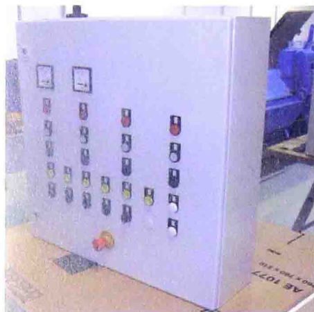
图 1-12 一台制糖机械的控制设备，这是一个典型的非个人机器的HMI
