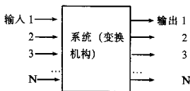
图1-2 多输入/输出系统示意图
