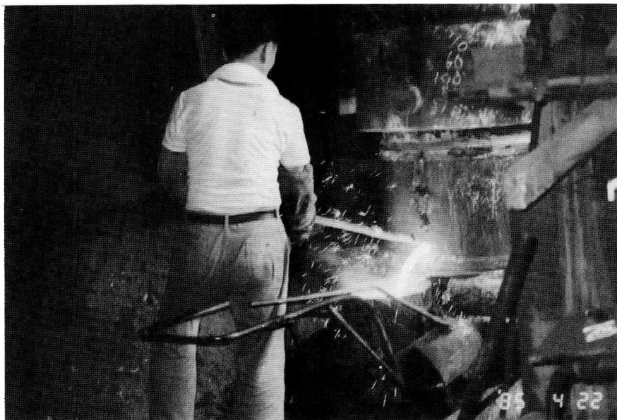
松の生木を差し込んで湯を止める、失敗はゆるされない。木は湯鉄に接すると炭化して、酸素がなければ燃えない。
