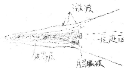
图 1—2 高超音速绕尖头细长体 流动图象
