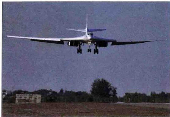
变后掠式下单翼，机身下进气，机翼与机身交界采用翼身融合结构。具有一定隐身能力。最大载弹量 40000kg。机身内有两个武器弹舱，弹舱内可载自由落体炸弹、短距攻击导弹或巡航导弹等。武器弹舱内的旋转发射架可各带 6 枚 AS-15B“撑杆”巡航导弹。后舱两个旋转发射架可带 24 枚 AS-16“反冲”空地导弹，也可带 12 枚 X-101 巡航导弹。也可带 BetAB-150DS/-250/-500/-500 ShP 侵彻炸弹、FAB-250M-54/-500M-54/-1500M-54 航爆弹、FAB-100M-62/-250M-62/-500M-62/-1000M-62 航爆弹、KAB-500S 卫星制导炸弹、AS-19“考拉”空地导弹。
