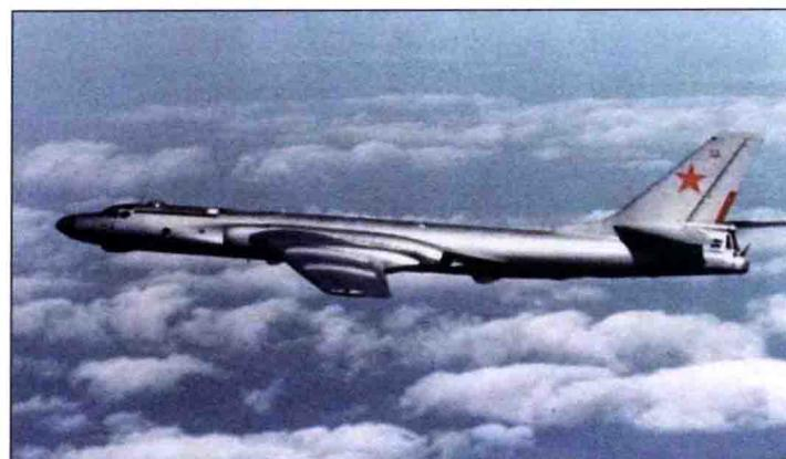
中单翼，机身两侧进气，半硬壳结构。最大载弹量 9000kg。可带 1 枚 2000kg 的遥控炸弹，或 2 枚 AS-6“王鱼”空地导弹或 AS-9“飞镖”反辐射导弹。可带 BetAB-150DS/-250/-500/-500 ShP 侵彻炸弹、FAB-250M-54/-500M-54/-1500M-54 航爆弹、FAB-100M-62/-250M-62/-500M-62/-1000M-62 航爆弹。出口埃及、伊拉克等国家。
