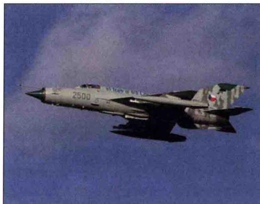
单人座舱，机头进气，三角形中单翼。主要用于截击作战，遂行对地支援、照相侦察等。5个外挂点。可挂2枚500kg炸弹，可带RBK-500U联合子母炸弹、PROSAB-250子母炸弹、RBK-500 BetAB子母炸弹、BetAB-150DS/-250/-500/-500 ShP侵彻炸弹、FAB-250M-54/-500M-54航爆弹、FAB-100M-62/-250M-62/-500M-62/-1000M-62航爆弹、AS-7“黑牛”空地导弹、AS-12“投球手”反辐射导弹。出口印度、越南、老挝等多个国家。
