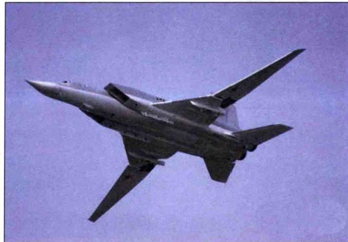
变后掠式下单翼，机身两侧进气，全金属半硬壳结构。最大载弹量 24000kg。机腹弹舱和机翼下 4 个挂架，机腹弹舱中可挂 12000kg 常规炸弹或半埋式携带 1 枚 AS-4 “厨房”空地导弹，或在翼下外挂 2 枚 AS-4 “厨房”空地导弹或 AS-6 “王鱼”空对地导弹，可在进气道下方挂架上挂 12 颗 500kg 炸弹。可带 BetAB-150DS/-250/-500/-500 ShP 侵彻炸弹、AS-9 “飞镖”反辐射导弹、AS-12 “投球手”反辐射导弹、AS-16 “反冲”空地导弹。可带 4 枚 X-101 巡航导弹。
