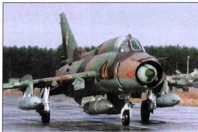
单人座舱，机头进气，悬臂式中单翼。主要用于对地攻击，遂行空战。9个外挂点。最大载弹量 4250kg。可挂 RBK-500U 联合子母炸弹、RBK-500 BetAB 子母炸弹、PROSAB-250 子母炸弹、FAB-100M-62/-250M-62/-500M-62/-1000M-62 航爆弹、FAB-250M-54/-500M-54 航爆弹、AS-7“黑牛”空地导弹、AS-9“飞镖”反辐射导弹、AS-10“克伦”空地导弹、AS-11“良好状态”反辐射导弹、AS-12“投球手”反辐射导弹、AS-13“中轴”空地导弹、AS-14“小锚”空地导弹、AS-17“氮”反辐射导弹、S-25L 空地导弹。出口越南、朝鲜等国家。
