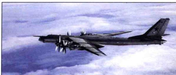
悬臂式中单翼，全金属半硬壳结构。最大载弹量 20000kg。正常载弹量为 10000kg。机身下可以半埋入式装载 1 枚大型 AS-3 “袋鼠”空地导弹或 1 枚 AS-4 “厨房”空地导弹。可携带 6 枚 AS-15A “撑杆”巡航导弹或 16 枚 AS-14 “小锚”导弹或 8 枚 X-101 巡航导弹。可带 BetAB-150DS/-250/-500/-500 ShP 侵彻炸弹、FAB-250M-54/-500M-54/-1500M-54 航炸弹、FAB-100M-62/-250M-62/-500M-62/-1000M-62 航炸弹、AS-6 “王鱼”空地导弹、AS-16 “反冲”空地导弹、AS-19 “考拉”空地导弹。
