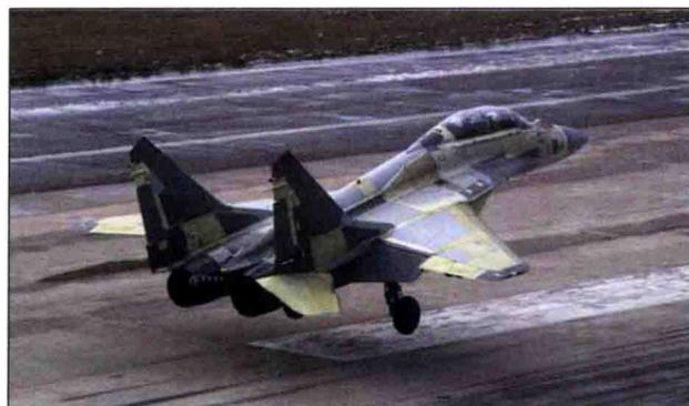
单人座舱，机身下进气，全后掠下单翼，双垂尾。原称米格-29M，与米格-29相比，加大了机背高度，增大了副翼、前缘襟翼和水平尾翼面积，水平尾翼前缘带锯齿，修改了进气道。主要用于空中截击，遂行对地攻击。9个外挂点，机翼下各4个挂点，机身下1个挂点。可挂RBK-500U联合子母炸弹、RBK-500 BetAB子母炸弹、BetAB-150DS/-250/-500/-500 ShP侵彻炸弹、FAB-250M-54/-500M-54航爆弹、FAB-100M-62/-250M-62/-500M-62/-1000M-62航爆弹、KAB-500Kr/-1500Kr电视制导炸弹、AS-14“小锚”空地导弹。
