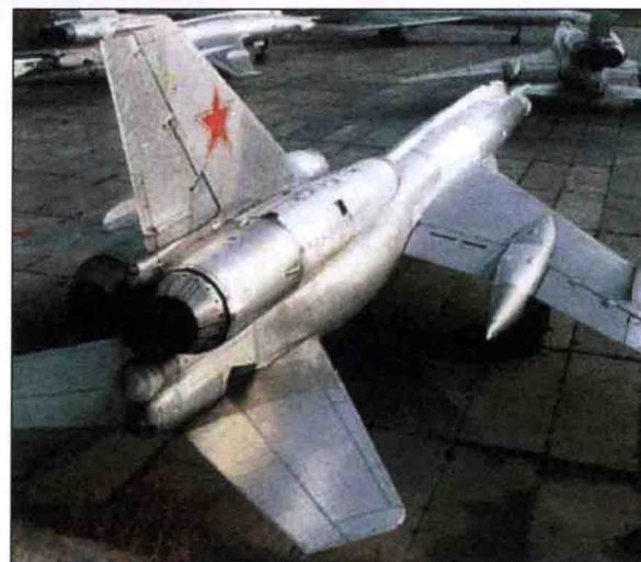
后掠式中单翼，全金属结构，蜂腰形机身，机身上部进气，2 台涡轮喷气发动机装在垂直尾翼两侧。最大载弹量 12000kg。双折门弹舱在机身中部。弹舱内装 24 枚 500kg 或 1 枚 9000kg 炸弹，可半埋入式装挂 1 枚 AS-4 “厨房”空地导弹或外挂 1 枚 AS-6 “王鱼”空地导弹。可带 BetAB-150DS/-250/-500/-500 ShP 侵彻炸弹。出口利比亚、伊拉克等国家。
