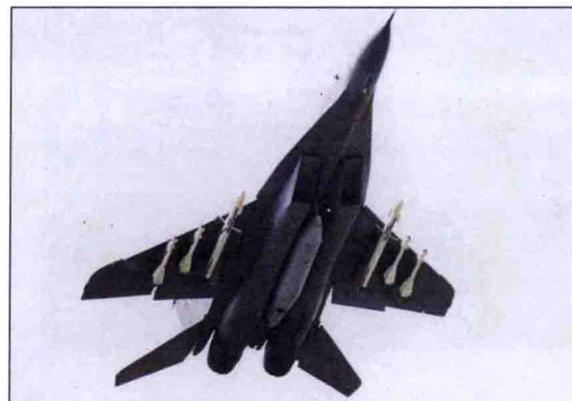
单人座舱，机身下进气，悬臂式下单翼，双垂尾。主要用于空中截击、战斗护航，遂行对地攻击、战术侦察。7个外挂点。最大载弹量3000kg。可带RBK-500U联合子母炸弹、RBK-500 BetAB子母炸弹、BetAB-150DS/-250/-500/-500 ShP侵彻炸弹、FAB-250M-54/-500M-54航炸弹、FAB-100M-62/-250M-62/-500M-62/-1000M-62航炸弹、KAB-500Kr/-1500Kr电视制导炸弹、AS-14“小锚”空地导弹、AS-17“氮”反辐射导弹。出口印度、韩国等国家。
