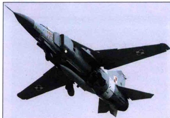
单人座舱，机身两侧进气，悬臂式变后掠上单翼。主要用于空战，遂行对地攻击。5个外挂点：左右进气道下各1个，后机身左右肩部各1个和机身下中央1个（米格-23没有翼下挂架）。最大载弹量2000kg。可外挂 FAB-250M-54/-500M-54 航爆弹、FAB-100M-62/-250M-62/-500M-62/-1000M-62 航爆弹、AS-7“黑牛”空地导弹、AS-12“投球手”反辐射导弹、AS-14“小锚”空地导弹。主要出口印度、越南等国家。
