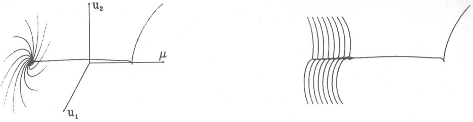
Figure 1: Trajectoires issues de points tels que \|u\| = 1 , pour \mu = -1.3 et divers angles (à gauche), ou divers \mu \leq -1.3 (à droite). On observera la sortie en \mu \approx +1 (c'est le retard), commune à toutes ces trajectoire (c'est la butée).
