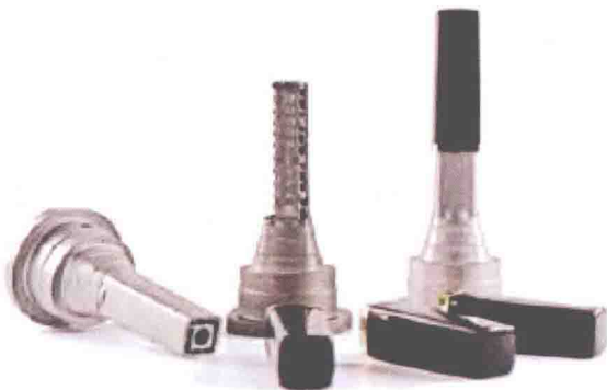
图1-10 口红盖里层的高性能模具
