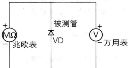
图 1-4 用兆欧表和万用表检测二极管的反向击穿电压
