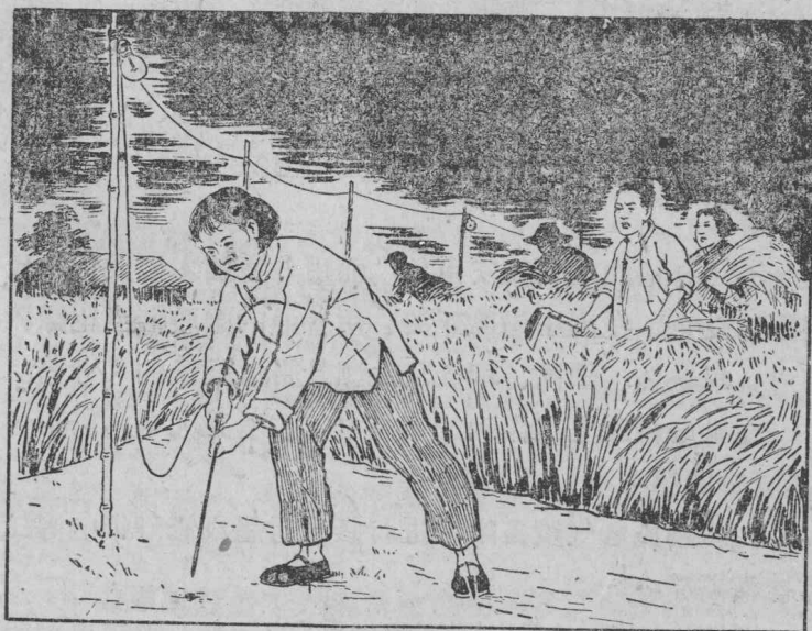
图 1-1 用一綫一地制安裝電燈所造成的觸電危險
