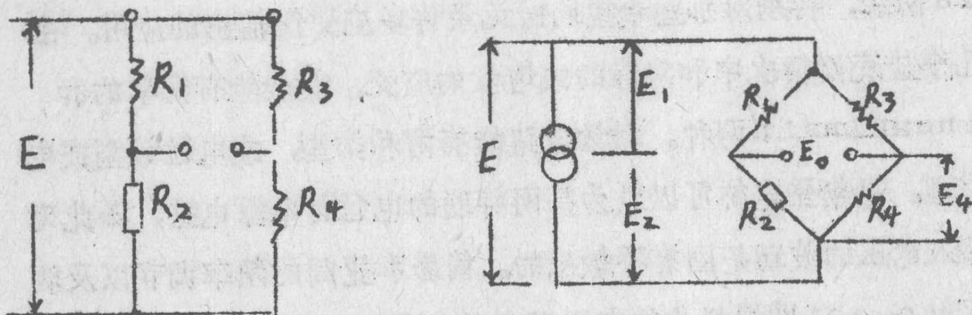
对原始的“平衡”电桥， $E_4 = E_2$ ，当  $R_3$  变成  $(R_3 + \Delta R_3)$  时， $E_2$  变成  $(E_2 + \Delta E_2)$ 。因而，
