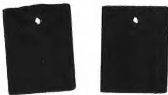
图5 LT-21 铝合金 101 堆内辐照腐蚀样品 (4 年)
