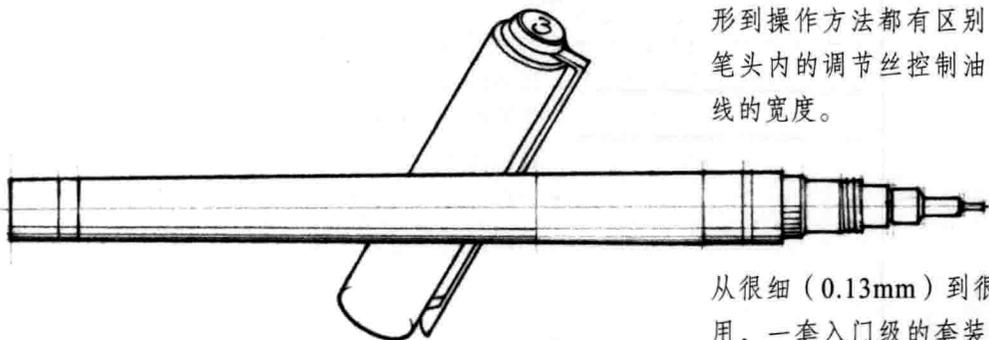
从很细（0.13mm）到很粗（2mm），有9种笔尖尺寸可用，一套入门级的套装针管笔应包括由国际标准化组织（ISO, the International Organization for Standardization）规定的4种线宽规格——0.25mm、0.35mm、0.50mm和0.70mm。
