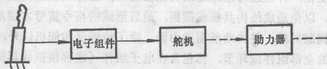
图2-2 直接电气传动系统示意图
