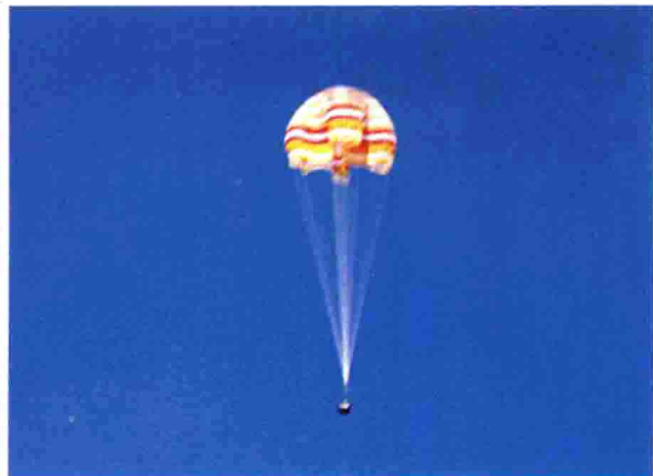
▲ 零高度逃逸救生飞行试验之五：“神舟”号飞船返回舱打开主降落伞，并抛掉防热大底，准备安全着陆
