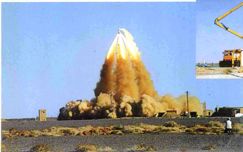
◀ 零高度逃逸救生飞行试验之三： 逃逸主发动机和逃逸控制发动机正在点火工作，逃逸飞行器在飞行中
