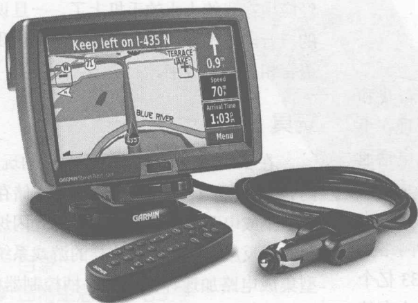
图1-3：在使用GPS接收机前，我们是怎么找到路的呢？型号为Garmin街道领航员7200的导航仪是为汽车使用而设计的，用以显示地图和行驶线路，并从点烟器插孔供电。电池供电的手持式导航仪，如型号为麦哲伦海王星的导航仪，深受远足等户外爱好者们的欢迎。
