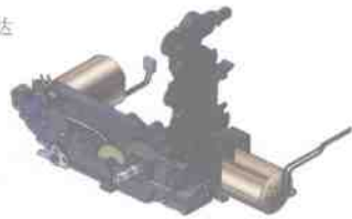
尼康、索尼、宾得等数码单反相机机身内部所安装的自动对焦驱动马达
