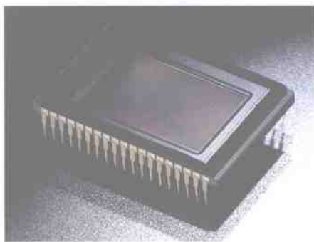
影像传感器能够将光线转换为电信号
