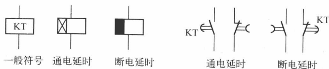
图 1-16 时间继电器的图形符号和文字符号
