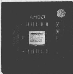
但令人遗憾的是, 毒龙的L2 Cache总线的宽度只有64bit, 是新赛扬256bit的四分之一, 这影响了它的传输带宽。Duron采用了0.18微米的铝制造工艺, 具有128KB的一级缓存和64KB的全速二级缓存, 采用成本较低的426针的Socket A架构, 支持MMX和增强型3D Now! 指令集, 使用200MHz EV6外部总线。
