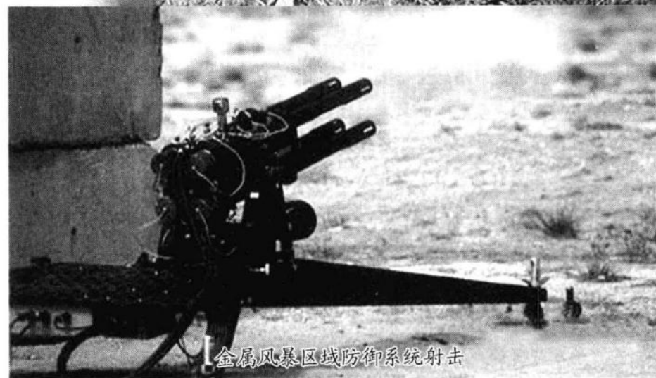
XM312 重机枪。快速更换几个零件可变成 25 毫米 XM307 榴弹发射器
