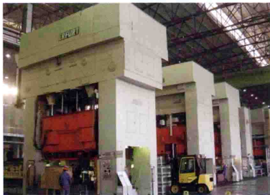
冲压车间冲压设备
