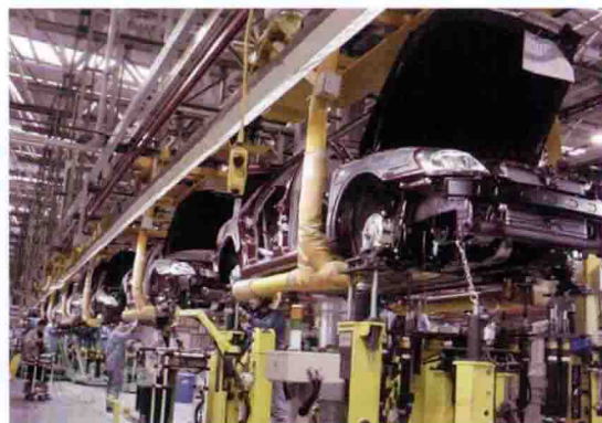
总装车间流水线
