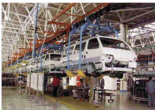
总装车间流水线
