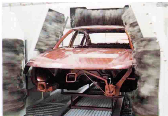
喷漆前用驼毛机清除车身内外的灰尘
