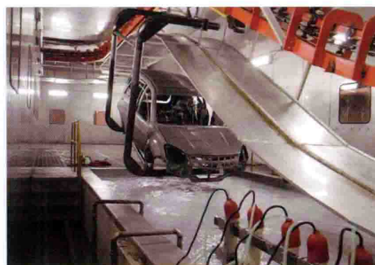
车身进入阳极电泳槽进行阳极电泳漆涂装
