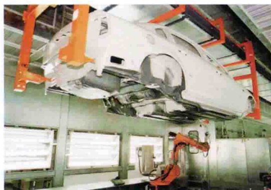
车身底部用机械手自动喷涂 PVC 防震隔热胶
