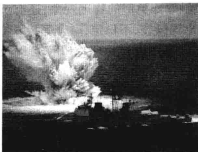
图 1.2.1 美国驱护舰海上实船水下爆炸试验
