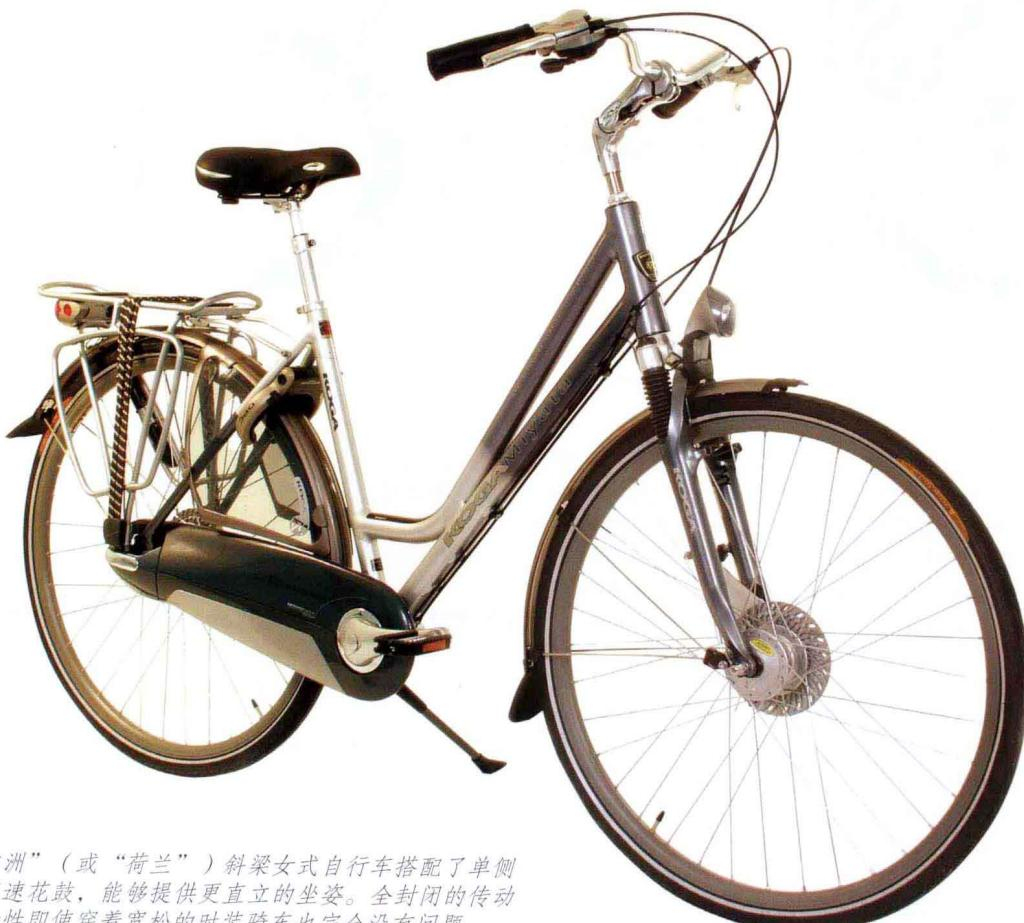
这款“欧洲”（或“荷兰”）斜梁女式自行车搭配了单侧车支和变速花鼓，能够提供更直立的坐姿。全封闭的传动系统使女性即使穿着宽松的时装骑车也完全没有问题。
