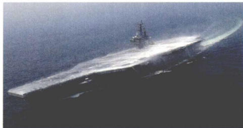
上图：美国“尼米兹”级航空母舰“罗纳德里根”号。这是“里根”号即将服役前进行舰载清洗系统测试的场面，该系统主要用来清除核生化遗留物。
