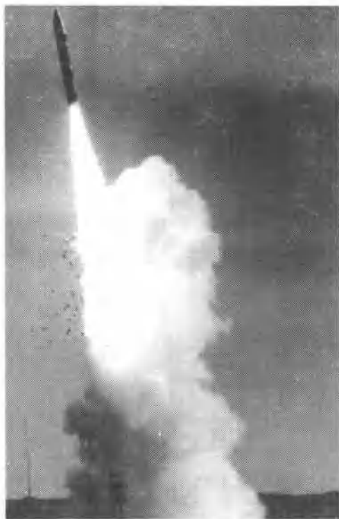
“和平卫士”洲际弹道导弹升出发射井，当气体发生器将导弹推出井面约 30 米后，导弹的第一级火箭点火。
