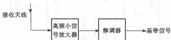
图 1.1-6 直接放大式接收机组成框图
