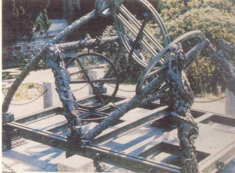
▲ 简仪，元代科学家郭守敬于1276年制成，世界最早的赤道仪。现存于紫金山天文台的是明代的复制品。
