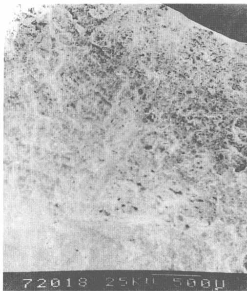
图7 瞬断区韧窝形貌
