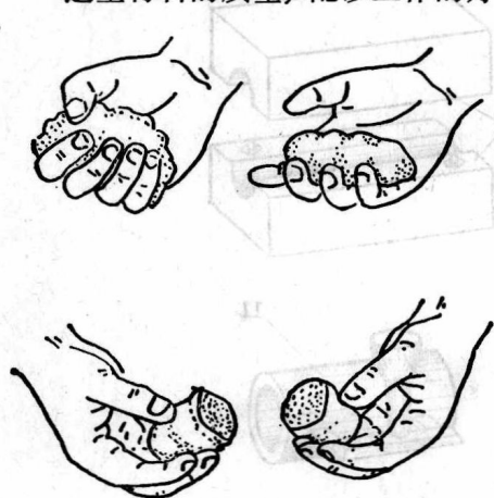
图 1-3 型砂性能检验法
