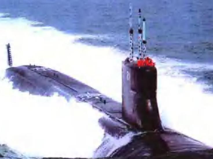
1997年7月19日由美国通用动力公司电船厂承建的美海军最新核动力攻击潜艇“海狼”号加入现役。该舰是美国海军自“跳鱼”(SSN-585)号核潜艇以来,时隔28年接受的全新型艇,与洛杉矶级核潜艇相比较,无论水下速度、潜艇下潜深度、攻击能力、安静性都有大幅度提高。水下排水量9137吨,全长107.6米,宽12.9米,水下速度35节,有660毫米鱼雷发射管6门。动力系统采用了最新开发的输出功率达52,000马力的S6W原子反应堆。
