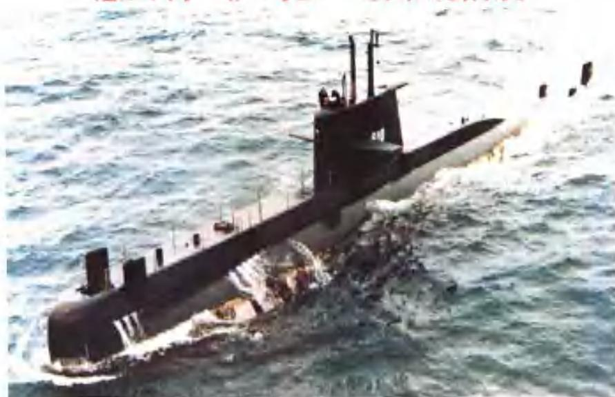
该艇是意大利现代化攻击型常规潜艇，共建有4艘，首艇于1980年服役，其水上排水量1456吨，水下排水量1631吨，艇长93.9米，艇宽6.8米，3台柴油机，水上航速11节，水下航速19节，6具533毫米艇首鱼雷发射管，可携载12枚“白头翁”线导鱼雷。
