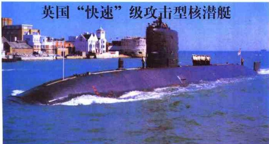
“快速”级艇现役6艘，均在1973~1981年间服役，其水上排水量4400吨，水下排水量4900吨，艇长82.9米，艇宽9.8米，水下航速30节，艇首5具鱼雷发射管可发射线导鱼雷和水下反舰导弹。
