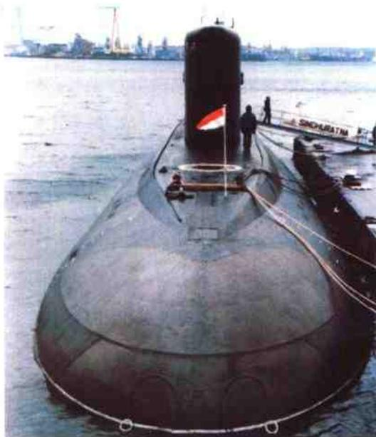
该级艇为印度从前苏联进口的，其性能与俄罗斯现役“基洛”级大体相当，其水上排水量2500吨，水下排水量3000吨，艇长73米，艇宽9.5米，水上航速11节，水下航速17节，装备6具533毫米鱼雷发射管，携带18枚印度造鱼雷。
