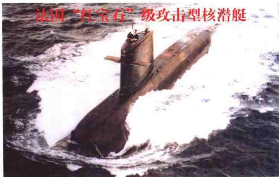
“红宝石”级攻击型核潜艇是性能相同的现役攻击型潜艇中最小巧的，首艇于1976年动工，1983年服役，其水上排水量2385吨，水下排水量2670吨，艇长72.1米，艇宽7.6米，水下航速25节。其装备的4具533毫米鱼雷发射管除可发射“飞鱼”导弹外，还可使用线导鱼雷，该级艇导弹、鱼雷备弹总数为18枚，水雷备弹总数为32枚。
