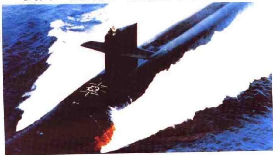
该级潜艇是目前在役核潜艇中性能最优异的一种，其水上排水量16600吨，水下排水量18700吨，艇长170.7米，艇宽12.8米，下潜深度可达300米。该艇水下航速达20节，自给力70天，编制155人，携载24枚“三叉戟”导弹，艇首4具533毫米鱼雷发射管可发射MK-48鱼雷。
