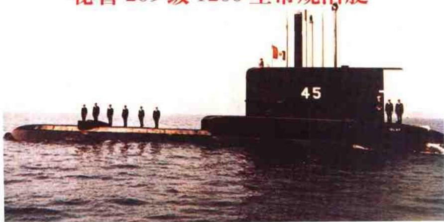
该艇为秘鲁从德国引进的，现役6艘，均在1974年到1983年间服役。其水上排水量1185吨，水下排水量1290吨，艇长56米，艇宽6.2米，水面航速11节，水下航速21.5节，编制53人，装备8具533毫米鱼雷发射管，可携载14枚A184鱼雷。
