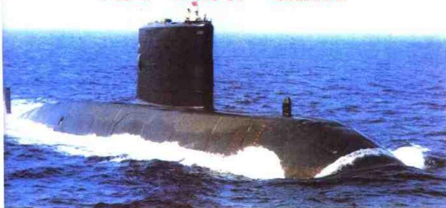
英国海军新型常规动力潜艇，现有4艘，首艇1990年入役。艇上装有射程130公里的“鱼叉”反舰导弹和射程13公里的“虎鱼”鱼雷。其水下排水量2455吨，艇长70.3米，艇宽7.6米，潜水航速20节，续航力1.288万公里，潜水深200米，艇员47人。
