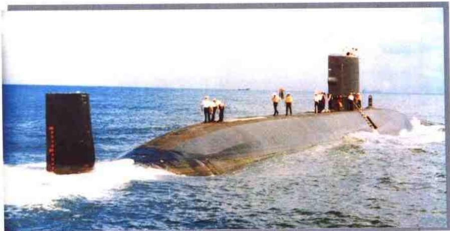
“特拉法尔加”艇是英国最新型的攻击型核潜艇，其水上排水量4200吨，水下排水量5208吨，艇长85.4米，艇宽9.8米，水下航速32节。除道制艇外，该艇首次在核潜艇上采用了喷水推进系统。该艇装备5具533毫米艇首鱼雷发射管，可携20枚“真旗鱼”鱼雷和潜射“鱼叉”导弹或相应的水雷。
