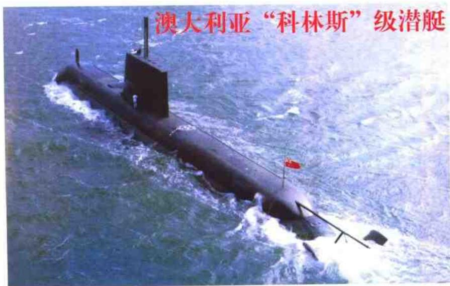
该级艇是澳大利亚从瑞典引进技术生产的，其水上排水量3051吨，水下排水量3353吨，艇长77.5米，艇宽7.8米，吃水7米，水面航速10节，水下航速20节，续航力11500海里，编制42人，装备6具533毫米鱼雷发射管，可发射鱼雷和“鱼叉”导弹，艇上共可装载23枚鱼雷和导弹，并可外挂水雷。该艇下潜深度250米。
