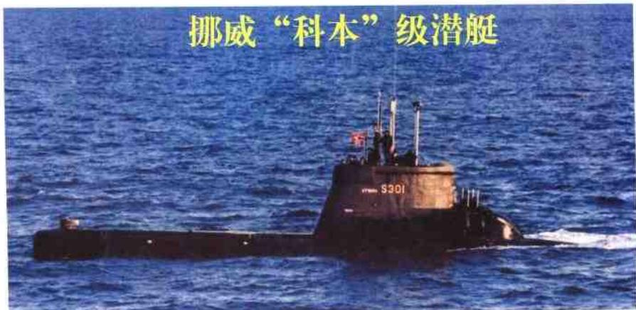
“科本”级也称207级，现役10艘，先后服役于1964~1967年间。其水上排水量459吨，水下排水量524吨，艇长47.4米，艇宽4.6米，水上航速12节，水下航速18节，装备8具533毫米鱼雷发射管，8枚61型反舰鱼雷和NT37C线导鱼雷。
