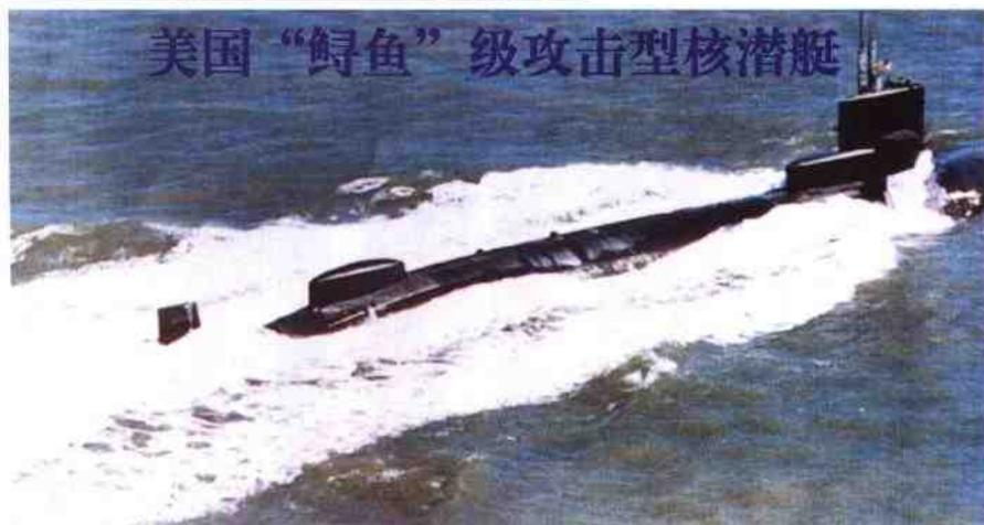
该级艇是美国攻击型核潜艇的主要力量之一，现役37艘，其水上排水量4250吨，水下排水量4960吨，艇长92.1米，艇宽9.7米，吃水8.8米，水上航速15节，水下航速30节，编制107人，下潜深度达500米，可在北冰洋冰冠下突破冰裂区结冰层。该艇艇体中部装有4具533毫米鱼雷发射管，载弹量为32枚，可配“鱼叉”导弹、“战斧”导弹、“萨布洛克”火箭和MK-48线导鱼雷。
