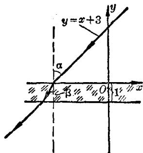
2.56. 一光线，在穿过厚 1 厘米的玻璃片（折射率<sup>①</sup> 为 1.5）以前，它的方程是  $y = x + 3$ ，设横轴位于这玻璃片的表面上，而纵轴垂直于此片（见图）。试求在此玻璃片内和出玻璃片后的光线方程，以及光线在玻璃片内的行程。
