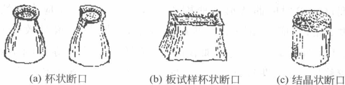
图 2.6 金属典型材料拉伸破坏断口
