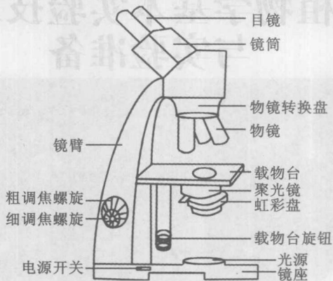
图 1-1 光学显微镜的结构
