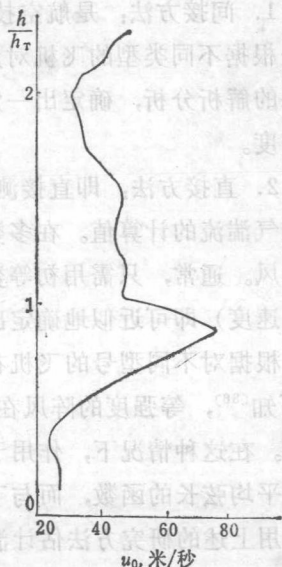
图 1.4 平均风速随高度的近似变化 ( h_T —对流层顶界区高度)
