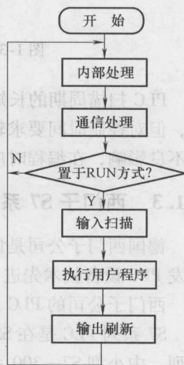
图 1-2 PLC 的工作原理示意图
