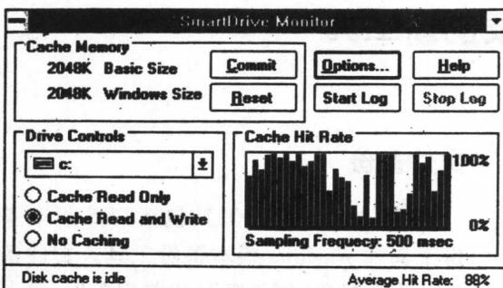
DOS 6 提供了 SMARTMON. EXE Windows 程序, 它与 DOS 和 Windows 所包括的磁盘超高速缓存程序 SMARTDRV. EXE 完全一致。用户可以在 Windows File 下拉菜单中的 Run 选项下运行 SMARTMON 程序, 或者在 DOS 6 生成的 Microsoft Tools 程序组中设置图标来运行它。正如此处所见到的, Windows 提供了系统的磁盘超高速缓存设置及各种超高速缓存活动的信息。
