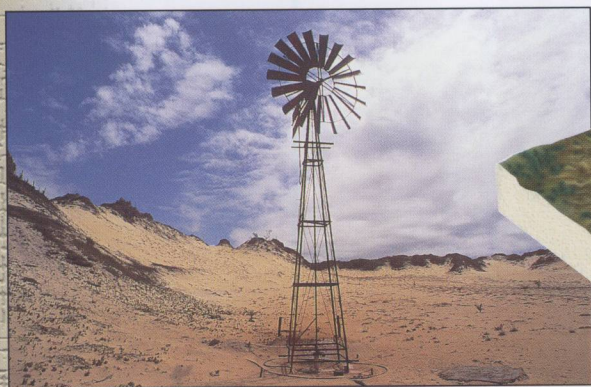
上层干旱，下层却有水：风力抽水泵将地下水泵入大的蓄水池中。这些蓄水在无风时也足够几周使用。
