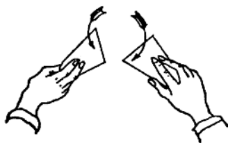
图 1—4 用刮刀填腻子的手势
