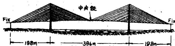
图—19 中间有铰的 Dame Point 桥（建设中）
