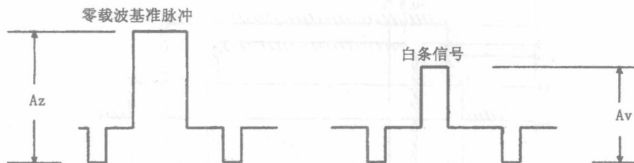
图 8-81 视频调制度测量波形图
