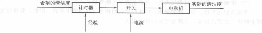
图 1-8 洗衣机的控制系统框图
