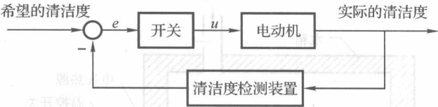
图 1-9 洗衣机闭环控制系统框图
