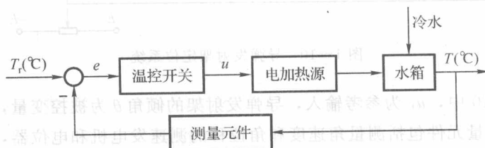
图 1-7 电加热器系统方框图
