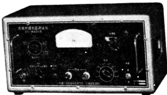
本仪器适用于电工绝缘材料和电工产品的高值绝缘电阻值的测量。仪器主要由 $10^{-12}$ 安高灵敏、高稳定的微电流放大器和高稳定的测试电源等组成。其虽用普通的电子管，但由于微电流放大器采用了特殊的自动补偿及差分电路作输入级，因而具有足够高的输入阻抗，满足了较高绝缘电阻值的测量。
