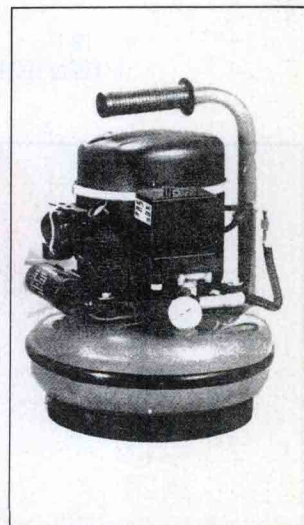
⑥ SILENT 2 MODEL 380-2 无声全自动空气压缩机 轻便手提式 无声全自动空气压缩机,宁静而无声,可同时供 4 支喷笔应用。 马达: 1/2 匹马力 电压: 220V 气压: 100PSI 体积: 13 英寸长 × 18 英寸高 × 13 英寸阔 重量: 20.9kg
