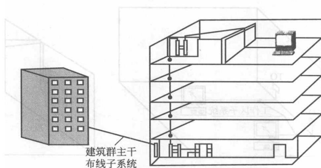
图 1-7 建筑群子系统示意图
